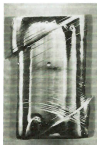
Figura 4 (a) – Fundamentos da plasticidade em metais mono e poli cristalinos. (Messner 1998) {11} (b) Tensão cisalhante resolvida e (c) monocristal de Nb comprimido {7}.
